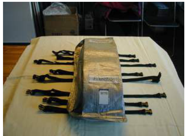
Bild 4: Thermo-Hygrometer und PermaPack-Zylinder in PermaBag einlegen und schließen
